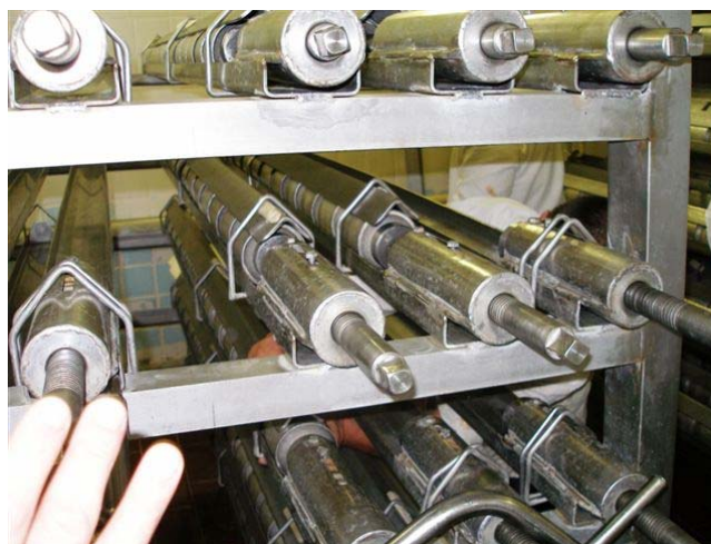
Il formaggio è avvolto in una pezza e poi lo stampo viene chiuso andando nella unità di pressurizzazione qui sotto
